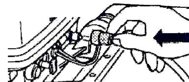
(3) При использовании выносного бака: Подайте топливо в карбюратор, сжимая клапан на топливном шланге, пока он не станет твердым.
